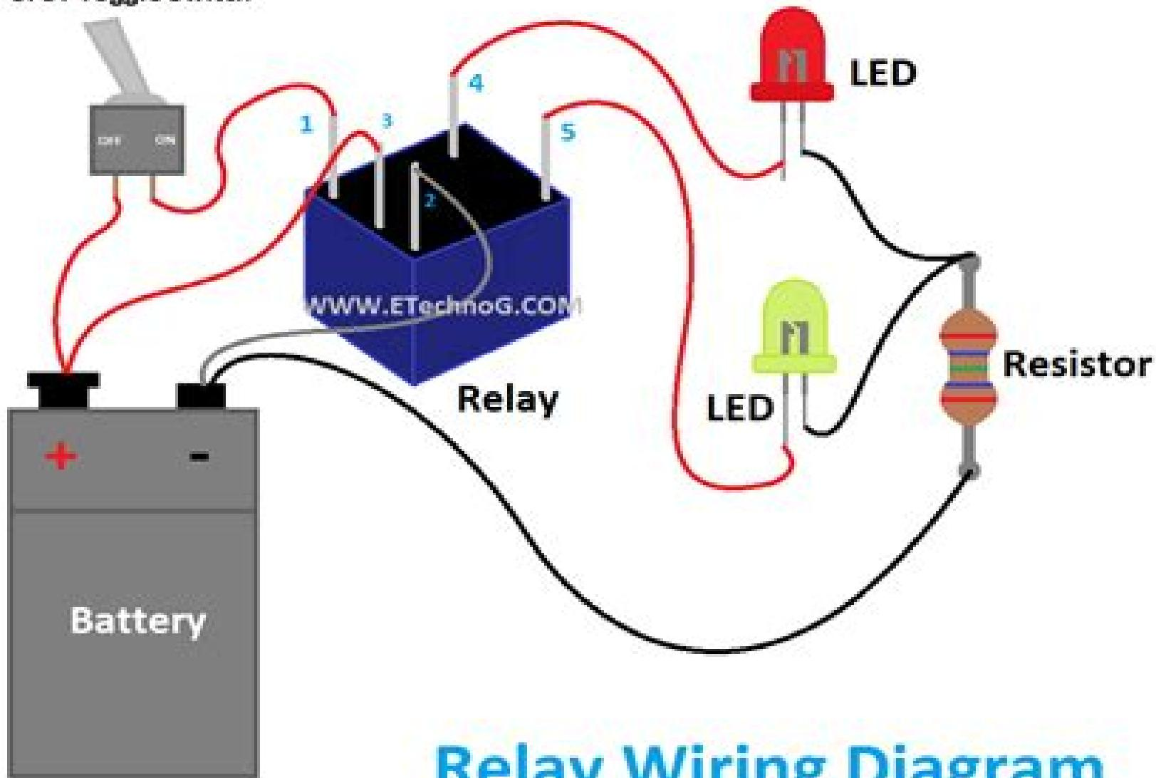
**Relay Wiring Diagram**
