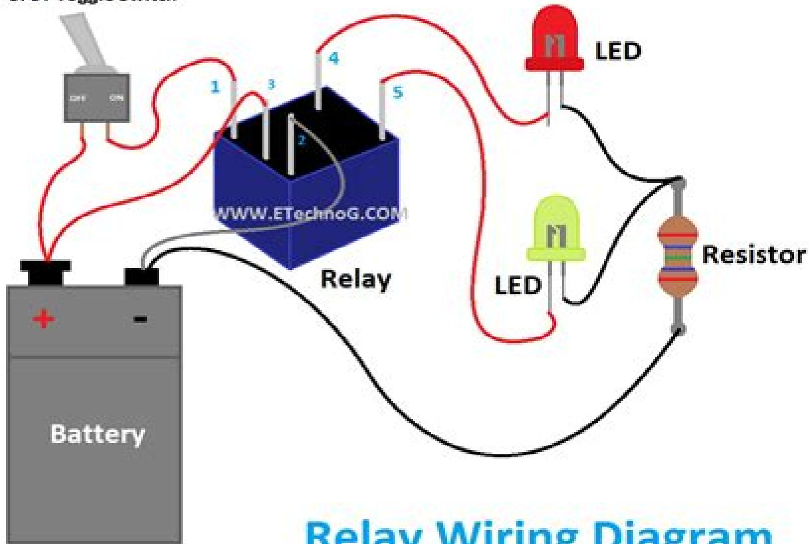
**Relay Wiring Diagram**
